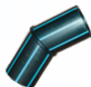
CURVA 30° SETTORE PE100 (MRS10) DERATING FACTOR 0,8 (COEFFICIENTE DI RIDUZIONE) NORME: EN 12201-3 racordi per distribuzione dell'acqua
