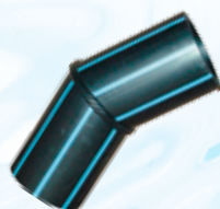
CURVA 22° SETTORE PE100 (MRS10) DERATING FACTOR 0,8 (COEFFICIENTE DI RIDUZIONE) NORME: EN 12201-3 raccordi per distribuzione dell'acqua
