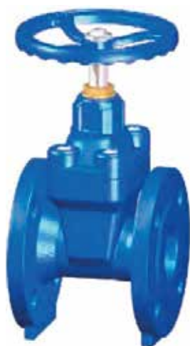
EN 1092-2 RF Ductile iron EN-JS1050 epoxy Guarnizioni EPDM Stelo ACCIAIO
